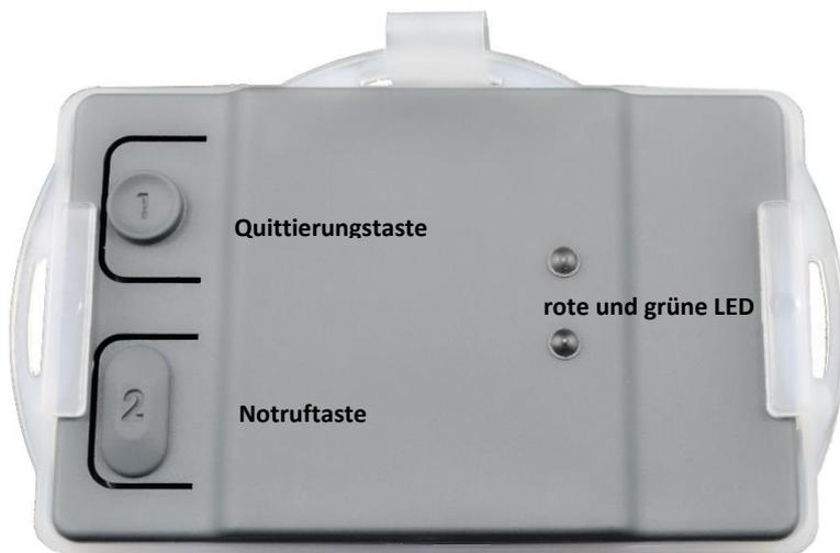
Abbildung 2 Personal-Transponder Rückansicht
